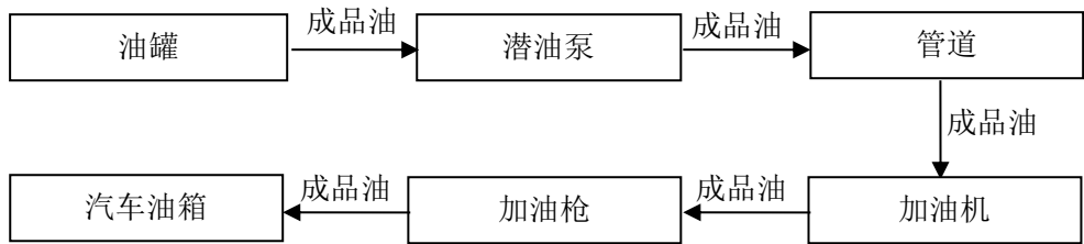
图5 柴油加油工艺流程图
